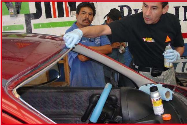
3. En caso de que existan rayaduras en el marco de la carrocería, se recomienda, después de haber sido aplicado el Sika®- Aktivator, usar el Sika Primer 206 G+P, para cubrir las rayaduras (agite el frasco durante 5min y aplique con una brocha, espere a que el primer se seque. Aprox 15min.
