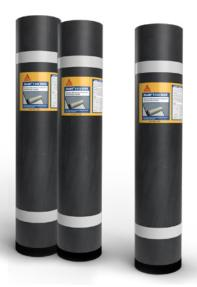
Es una membrana bituminosa autoadherible para impermeabilización compuesta de betún modificado con SBS sobre un lado contiene un terminado de arena, el cual se adherirá al concreto fresco formando una barrera resistente contra daño físico y migración de agua.
