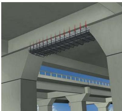
Ampliación de secciones en vigas para elementos estructurales.
