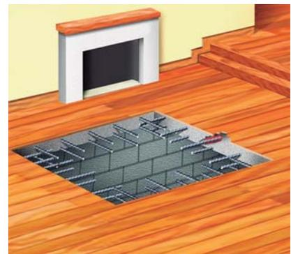
Recrecimiento de losas, conexiones de muros con losas.
