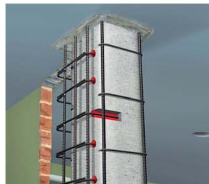
Ampliación de sección en columnas para reforzamiento estructurales.
