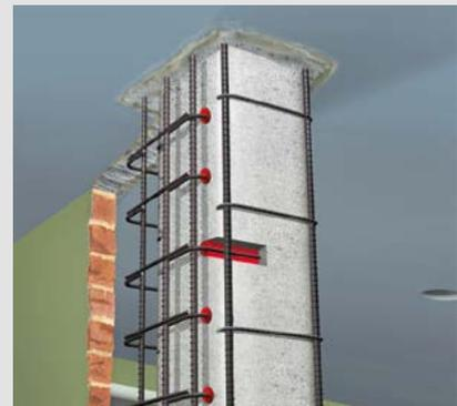
Ampliación de sección en columnas para reforzamiento estructurales.
