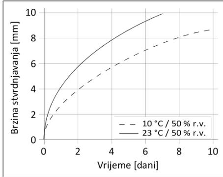
Diagrama 1: Velocidad de curado de SikaTack® DRIVE (60 min)
