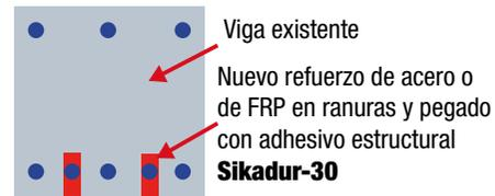
**Figura 15. Instalación de varillas en ranuras en el reforzamiento de una viga.**
