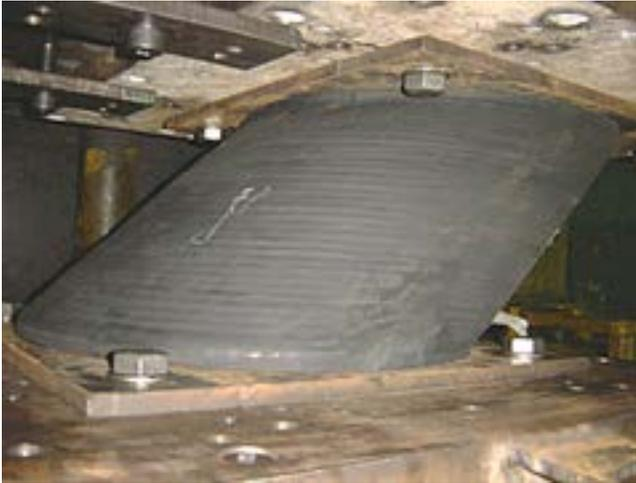
Prueba de aislador sísmico.
